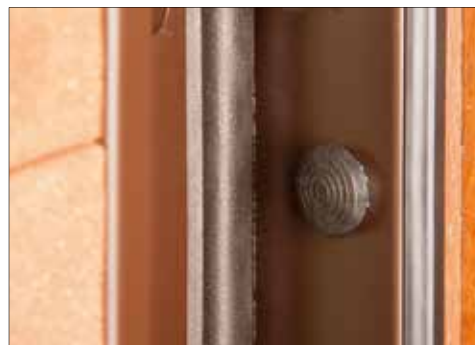
5- Puntali in gomma reggispinta. Assorbono la forza orizzontale, esercitata dal piede di porco, che va dal lato serratura verso il lato cerniera.
